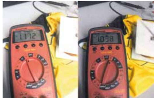
**Figura 13.** Multímetro y voltajes en AC y DC, respectivamente.
