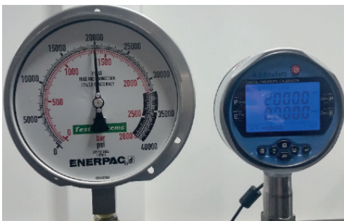
Figura 2. Manómetro analógico (IBC). Manómetro de referencia o manómetro patrón Fuente: elaboración propia con autorización de Calibration Service S. A. S.
