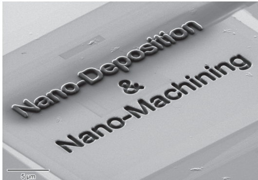
Figura 9. Grabado y deposición mediante FIB. Fuente: Fibics (2014).
