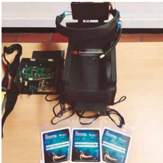
Figura 9. Prototipo a escala de Silla de ruedas con circuito de adquisición. Fuente: elaboración propia.
