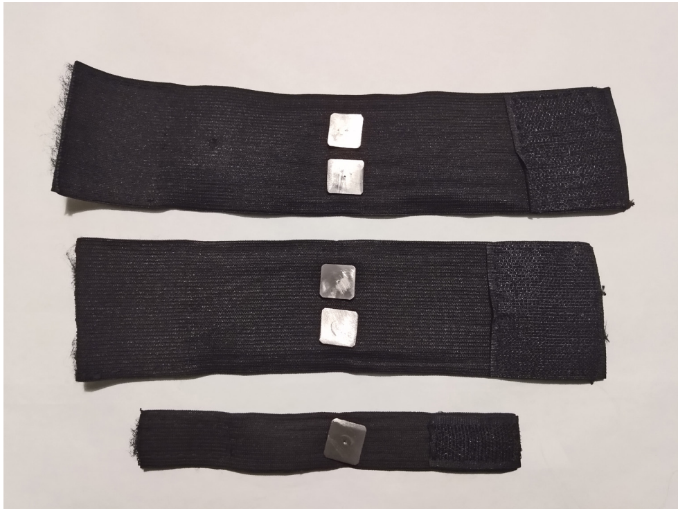
Figura 9. Electrodo de acero inoxidable ajustados en la banda elástica con velcro en los extremos (ajustes para el brazo).
