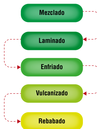
Figura 1. Etapas de la línea de producción de suelas. Fuente: elaboración propia.
